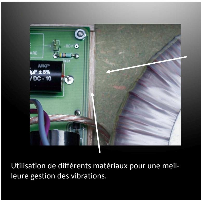
Le circuit imprimé est fixé par des matériaux mixtes (durs et souples); le transfo est amorti par un composé sable + absorbant.
